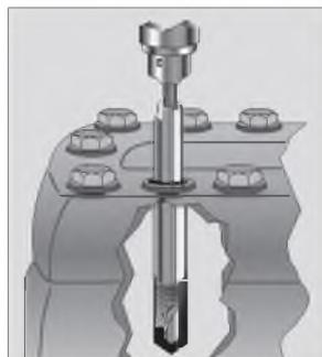
**ПЕРВОЕ** – Высверлите небольшое отверстие в сломанном винте с использованием направляющей втулки RIDGID для точного центрирования. Это центровочное отверстие служит для последующего прохода сверлом большего диаметра.
