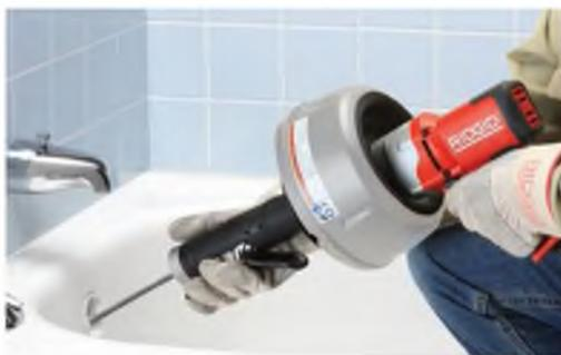
*Модель K-45AF быстро пробивает забитые трубопроводы в ванн. Подает и извлекает спираль без реверсирования двигателя*
