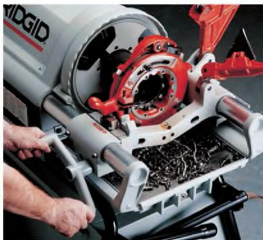
Резьбонарезная головка со ступенчатой регулировкой модели 714 (914).
