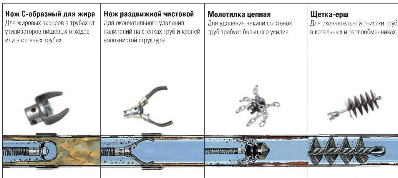
Для прочистного оборудования, барабанов для раковин и секционных машин для малых трубопроводов
