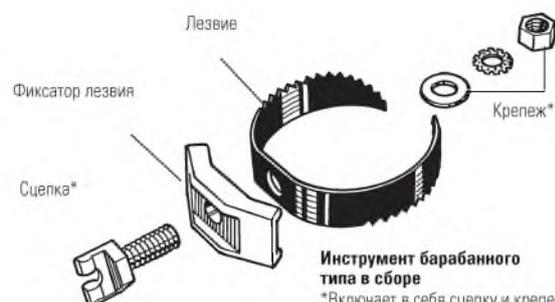
**Инструмент барабанного типа в сборе**
