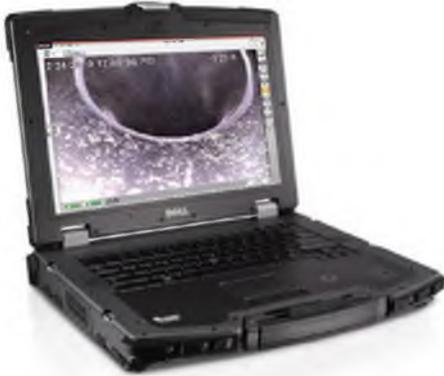
SeeSnake HQ - это мощное установленное программное обеспечение для контроля, записи и управления цифровыми данными видеодиагностики на месте выполнения работы. Запись и документирование полученных данных, запись на DVD и экспорт на USB-накопитель.
