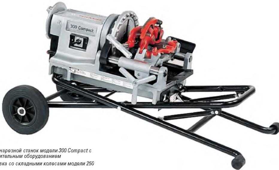
Резьбонарезной станок модели 300 Compact с
