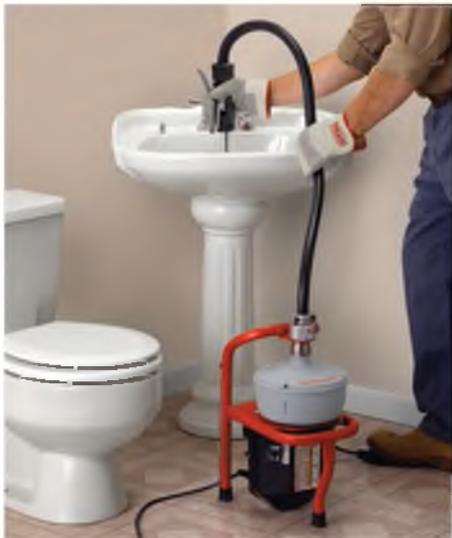
**В раковине:** нажимаете рычаг и спираль подается в сток. Сочетание уникального направляющего шланга и устройства автоподачи AUTOFEED® ставит вас непосредственно над проблемой.
