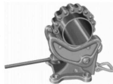
Уникальная конструкция модели позволяет легко и быстро настраивать тиски для работы с различными трубами. Оригинальная многорядная (3-5 линковая) цепь специальной закалки простым скольжением сквозь губки тисков быстро регулируется оператором под необходимый диаметр, после чего без усилий крепко фиксируется стяжным рычажным болтом. Тиски не заедают и не заклинивают даже при чрезмерной нагрузке.
