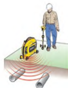
Наведение сигнала для определения положения инженерных сетей
