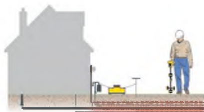
Прямое подключение к инженерным сетям
