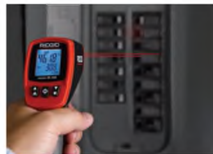
Проверка предохранителя или автоматического прерывателя на предмет перегрева, который могут вызывать перегруженные электрические цепи
