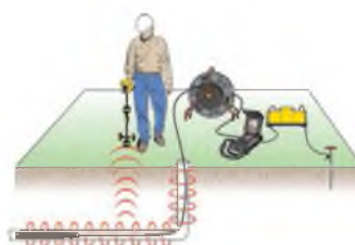
Поиск пластмассовых труб благодаря обнаружению труб с помощью встроенного передатчика
